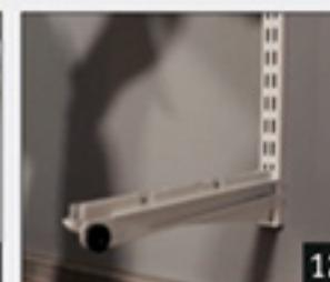
Установить направляющие кронштейны, слегка надавив на них до защелковывания фиксатора. Ролики на направляющих должны быть расположены спереди.
